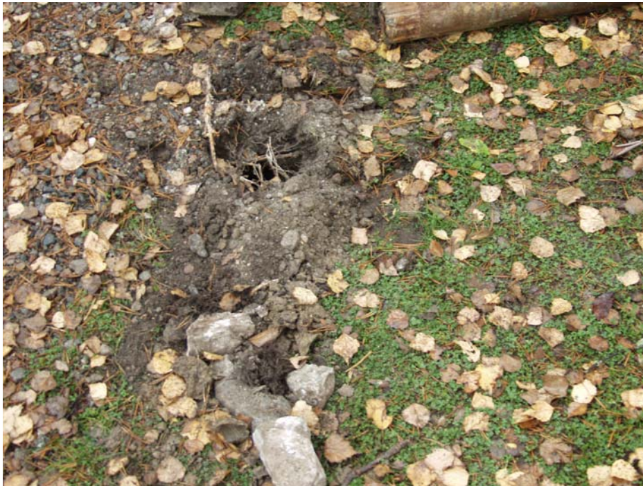
Figur 3: Exempel på hur borrhålen ser ut efter skruvborrningen. Fotograferat av Anna Lihammer, oktober 2006.
