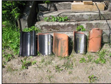
Figur 7. Taket var före omläggningen belagt med ett äldre svartglaserat tegel vilket i viss mån kompletterats med annat oglaserat handslaget tegel. Foto: Helén Sjökvist.
