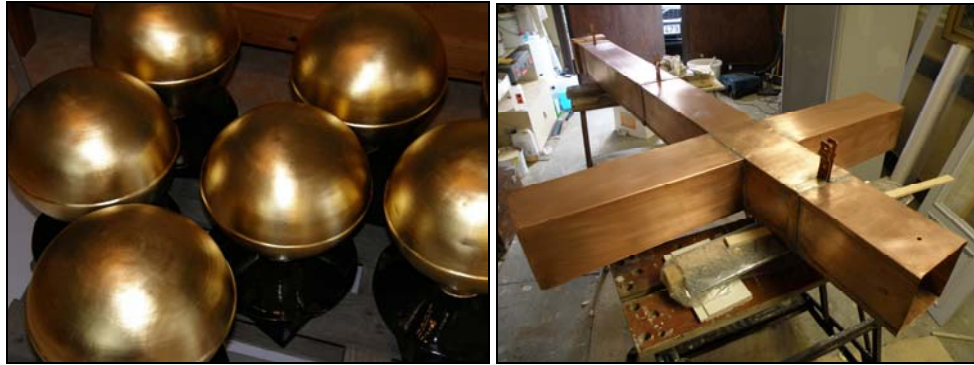
Figur 33. Kulorna är färdigförgyllda med två förgyllningslager. Foto: Claudia Sandner.
