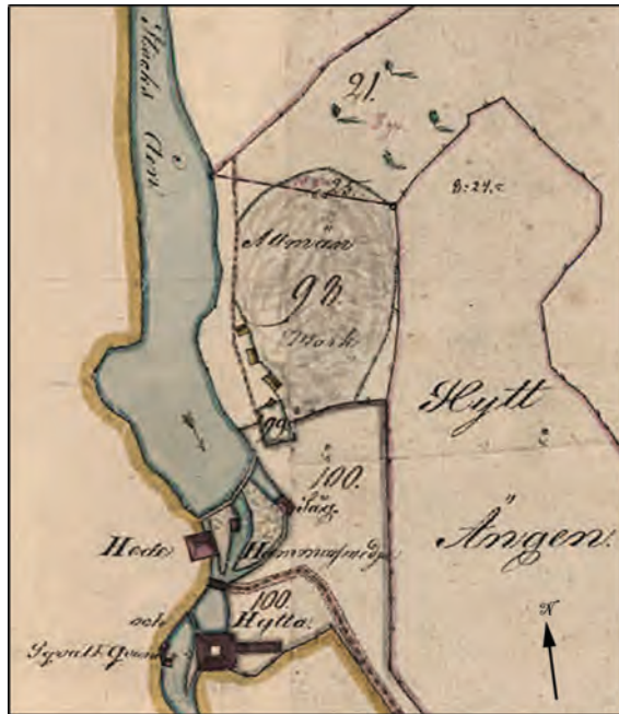
Fig. 9. Utsnitt ur laga skifteskartan över Buska 1840. Hammarsmedjan ligger väster om ån, liksom en skvaltkvarn nedströms. Sågen (i norr) och hyttbyggnaden (i söder) ligger öster om ån. Den numera uppodlade marken öster om området var då ängsmark med namnet "Hytt Ängen". Odefinierad skala.
