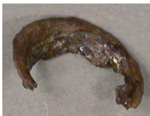
På insidan finns rester av tennlod.
