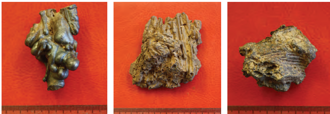
Figur 16. Exempel på slagg som finns på platsen: stearinlägg, slagg med gräsavtryck och slagg med avtryck av ved eller kol. Foto Jenny Holm.
