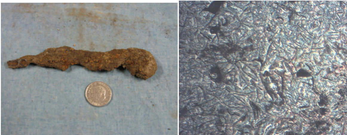
Mikrofotot visar grått tackjärn efter etsning (påfallande belysning, bildfält 0,82×0,58 mm).
