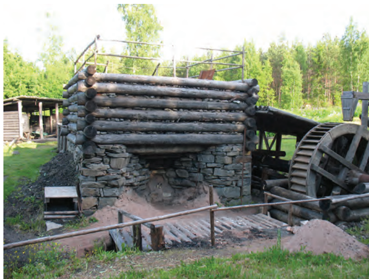
Figur 9. Nya Lapphyttan är en rekonstruktion av den masugn som undersöktes i Lapphyttan. I förgrunden ses utslagsbröstet och till höger ligger bälgbröstet. Fotograferat av Jonas Ros.
