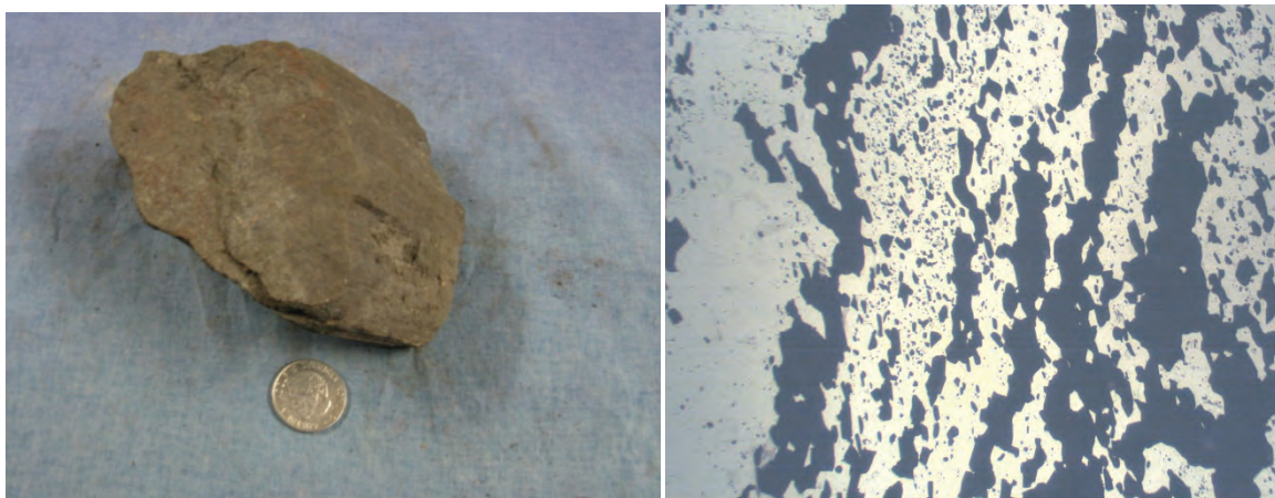
Blodstensmalm. Mikrofotot visar en vackert kvartsrandig malm (genomfallande belysning, bildfält 2,90×2,31 mm).
