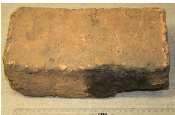
Figur 97b. Tegelsten med storleken 13,3×9×27 cm. I stenen fanns avtryck av fingrar som har uppkommit i samband med att stenen hanterades då den ännu inte var torkad. Fotograferat av Jonas Ros.
