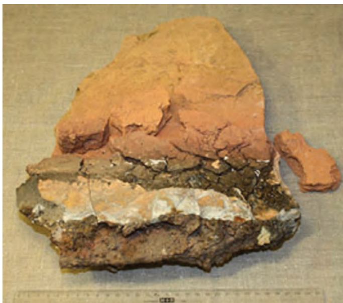
Figur 64. Sten från pipmuren. Stenen (fjr. 81) är en kvarts- och muskovitrik skiffrig bergart. På stenens ovansida finns foglera som bränts vid så hög temperatur att den blivit rödbränd och uppvisar likheter med tegel. På lera finns rester av en annan sten som suttit ovanpå. På pipans insida, framtill på bilden, finns lera som har smält. Fotograferat av Jonas Ros.
