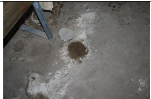
KM12114 Oljeön 20121008_47. I oljekällarens mitt var en mindre bit av golvet, ca 13 cm i diam, lös. Där togs prov J12-8 med spadborr.
