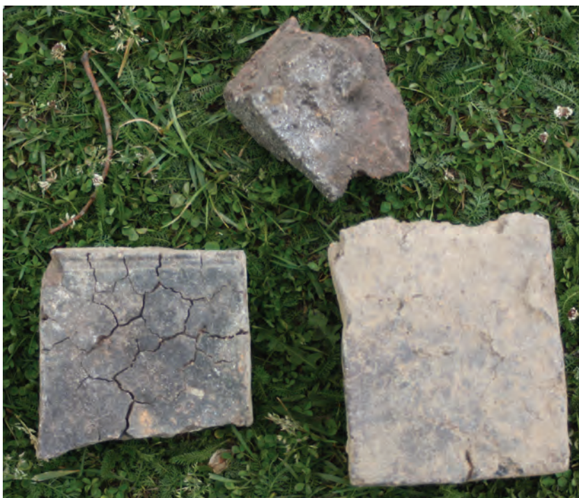
Figur 68. Exempel på felbrända, sintrade, tegelstenar som framkom vid undersökningen av ugnarna. Fotograferat av Jonas Ros.
