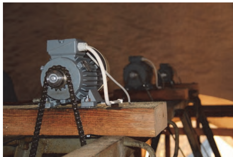
Figur 30. Nya motorer till ringningen, tillverkade av Bergholtz. Foto: Lisa Skanser.
