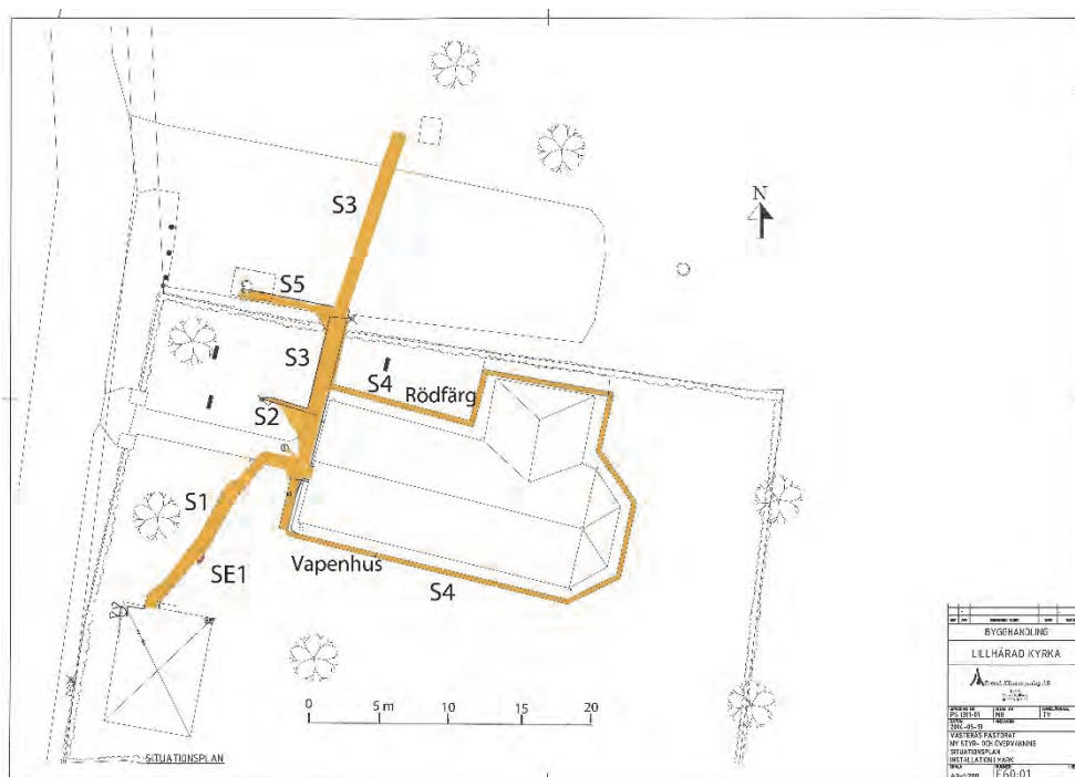
Figur 4. Lillhärad kyrka. De upptagna schakten är markerade med orange färg och numrerade schakt 1–4 (S1–S4). Schakt 4 sträckte sig runt om söder, öster och norr om kyrkan. Läget för sektion 1 (SE1) är markerat. Karta från Svensk Klimatstyrning. Skala 1:600.
