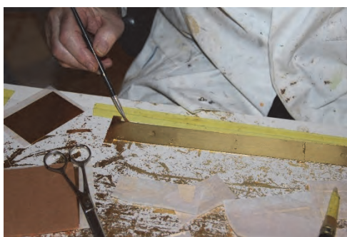
Figur 45. Förgyllningsarbete på urtavlans siffror. Foto: Lisa Skanser.
