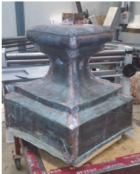
Figur 21 och 22. Metod 1. Piedestalens falsar har öppnats upp helt och slipats, därefter löts ihop. Då falsarna öppnas upp och böjs åt sidan för åtkomst för slipning och rengöring sker åverkan på den gamla sköra kopparplåten som får brottytor. Foto: Lisa Skanser.
