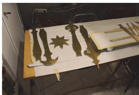
Figur 45. Förgyllningsarbete på urtavlans siffror. Foto: Lisa Skanser.
