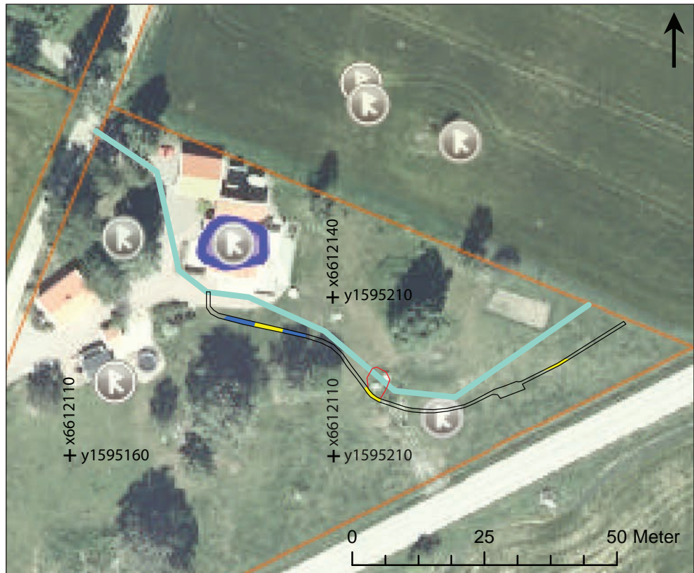
Figur 5. Schaktplan i skala 1:1 000. Ljusblå linje visar den planerade sträckningen för VA-ledningen och fibernätet. Ortofoto från FMIS, © Lantmäteriet.
