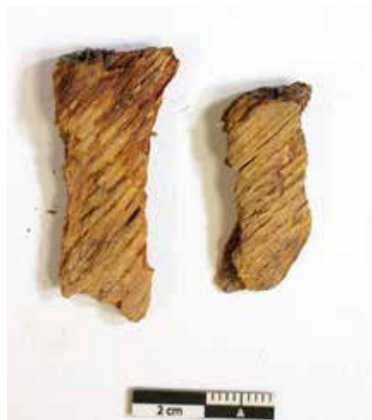
Spikskافت, två avbrutna lösa spikskافت, med bevarade träfibrer. Träfibrernas riktning går vinklade snett mot spikskافتen (kan de ha suttit genom hinkens botten?).
