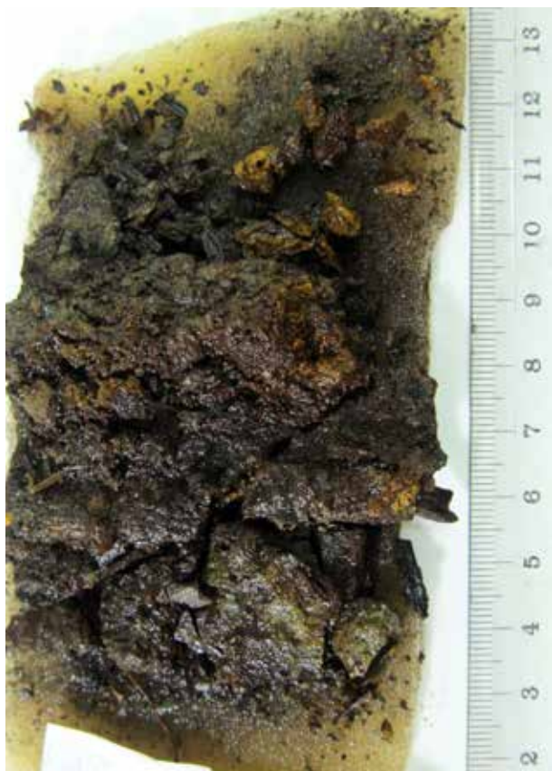
Del 8:1 före konservering, jordigt och söndertrasat järnband på trä samt rester av kopparbeslag.
