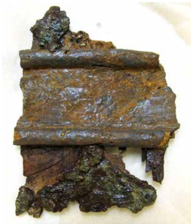
Del 8:1. Efter att alla lösa delar limmats fast, konsolidering utförts på allt fysiskt instabilt material och frampreparering för att frilägga originalytor har utförts.
