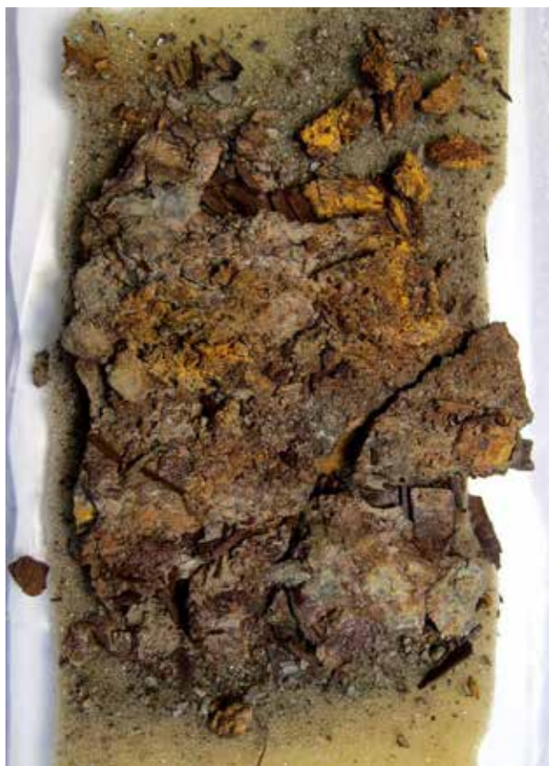
Del 8:1 Samma del efter PEG-impregnering och vakuumfrystorkning. Extremt trasigt, järnbandet har ett flertal brott och delarna ligger lösa.
