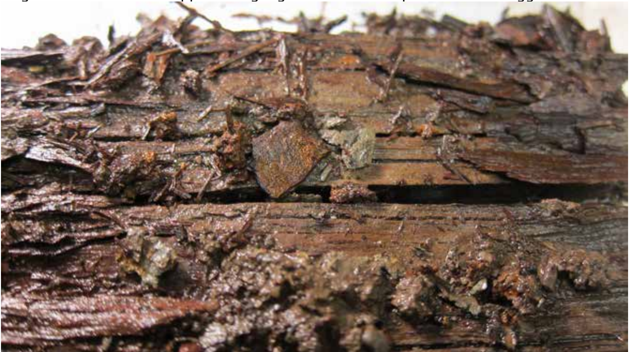
Närbild av ytan på samma del med mängder av lösa krossade fragment av kopparbeslag och lösa träfibrer samt jord.
