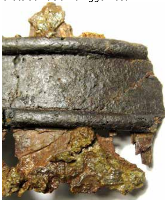
Del 8:1 Samma del efter PEG-impregnering och vakuumfrystorkning. Extremt trasigt, järnbandet har ett flertal brott och delarna ligger lösa.
