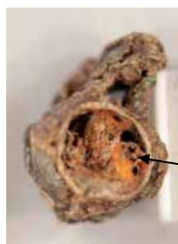
Genom- korroderad nål, från sidan.
