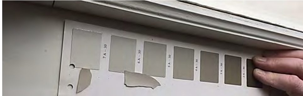
Figur 8. Jämförelse mellan flagor från befintlig färgsättning och RAA:s linoljefärgslikare. Foto Louise Lorichs.
