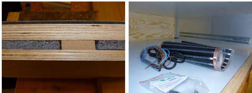
Figur 4. Stommen har en mellanskiva av polyetylen. Foto Helén Sjökvist.
