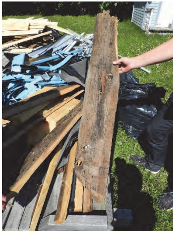
Figur 31. Utbytt panel. Foto: Helén Sjökvist.
