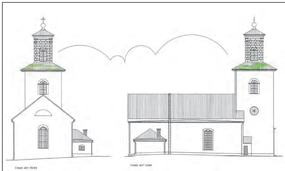
Figur 36. Omfattning på byte av takpanel mot öster och norr. Markeringar utförda av Aros plåt och vent AB.
