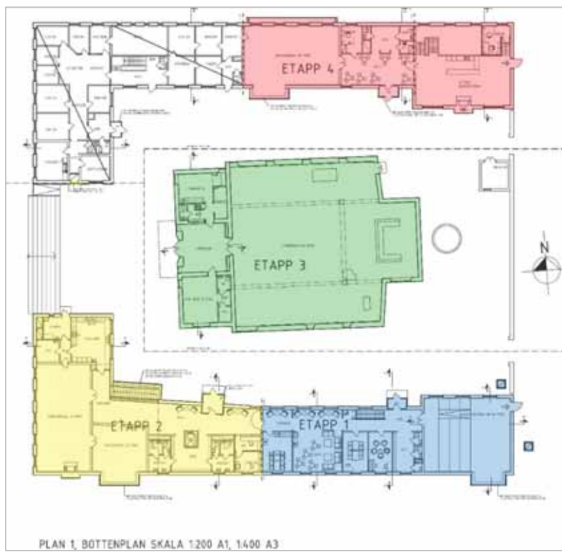
Figur 4. Etappindelning av bottenplanen.
