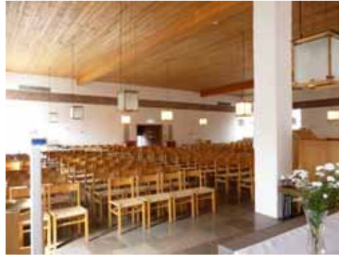
Figur 181. Befintlig armatur i taket över körgradäng. En förlängning av armaturen har gjorts tidigare i den övre delen.
