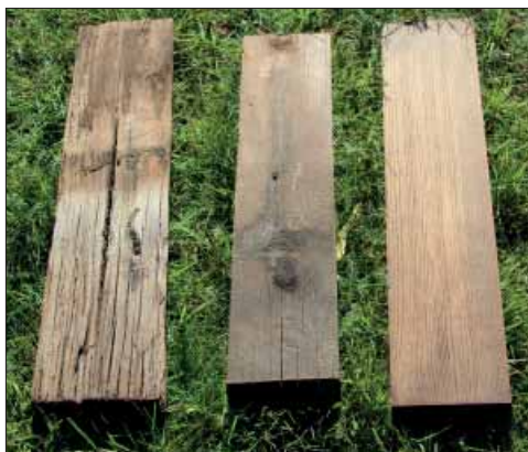
Möklinta klockstapel. Bleket på tre olika spån från 1900-talet som förekommer på klockstapeln. Till vänster ett hugget spån som troligen är samtida med de som lades på kyrkan 1931–32. Denna typ är dominerande på tak och fasader. Spånet i mitten är ett sågat spån sannolikt från 1953. Spånet till höger är kreosotspån eventuellt från 1982
