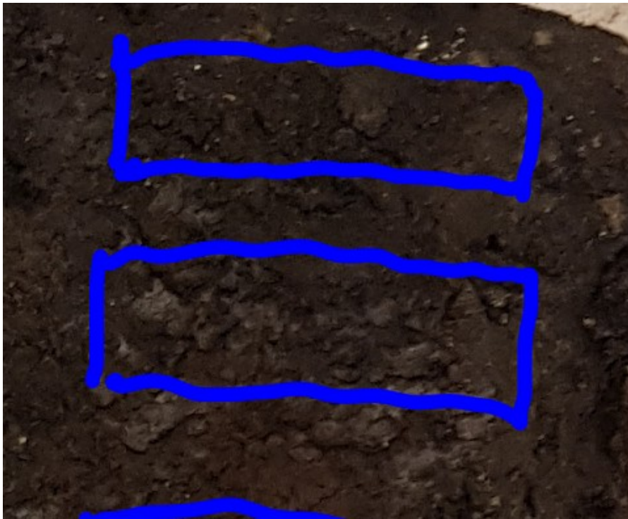
Figur 3: Markstrukturen i provpelarens övre del är kornig eller grynig och stöder antagandet att materialet rasat ner till platsen genom ett skred.
