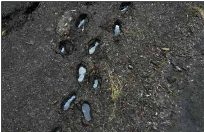
Figur 6.30. Stora delar av dammens nyligen torrlagda botten var vattensjuk och mjuk, inom dessa ytor lämnade varje steg djupa vattenfyllda stövelavtryck.
