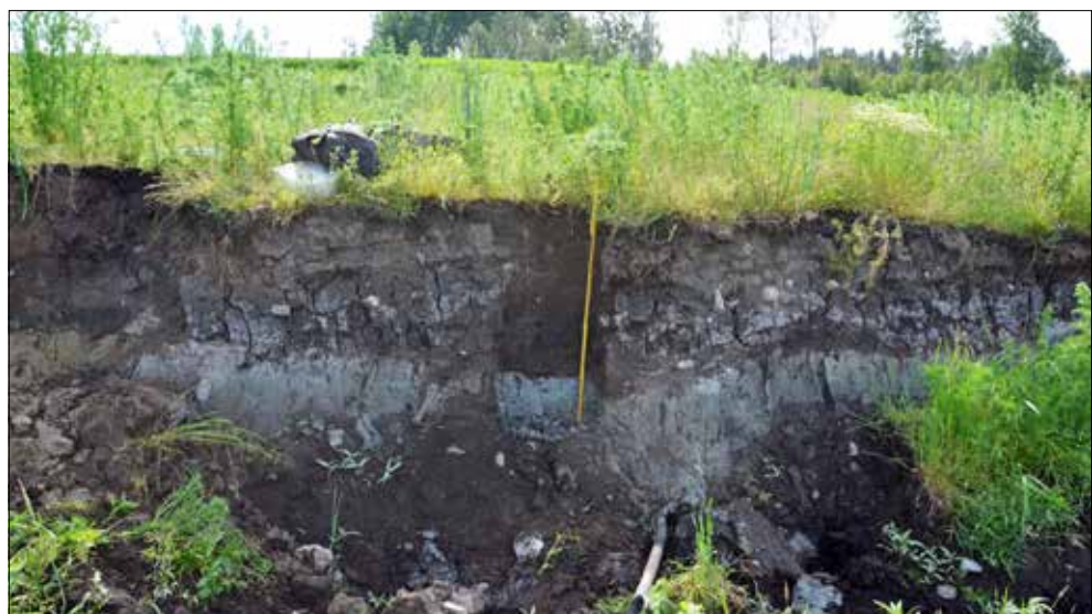
Figur 7.20. Lagerföljden som blottats i skredbranten mot drumlinen provtogs för kvartärgeologisk analys (bilaga 3). I botten syns lera som överlagras av alkärrstov, lövkärrstov, svämtorv och (förmodligen) nedbruten lövkärrstov. Då området är skredbenäget är det möjligt att delar av lagerföljden sedan tidigare påverkats av marksförskjutning, skred och omlagring.
