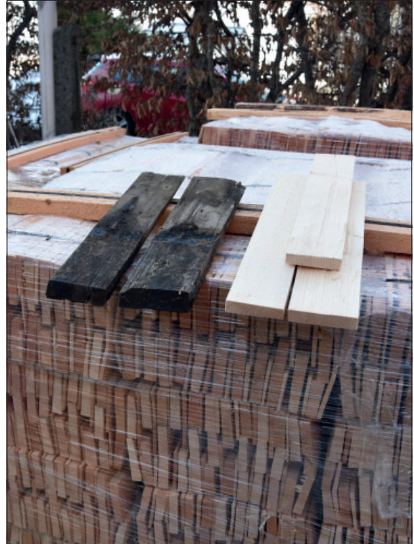
Figur 12. Avvikelse i utseende noteras. De äldre spånen har en avfasad avslutning.
