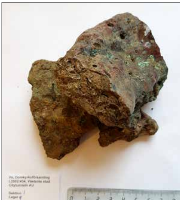
Figur 37a och 37b. Förslagget material, sannolikt del av ugnsvägg till kopparsmide. Fotografierna visar samma fynd från två olika sidor (fnr 5).
