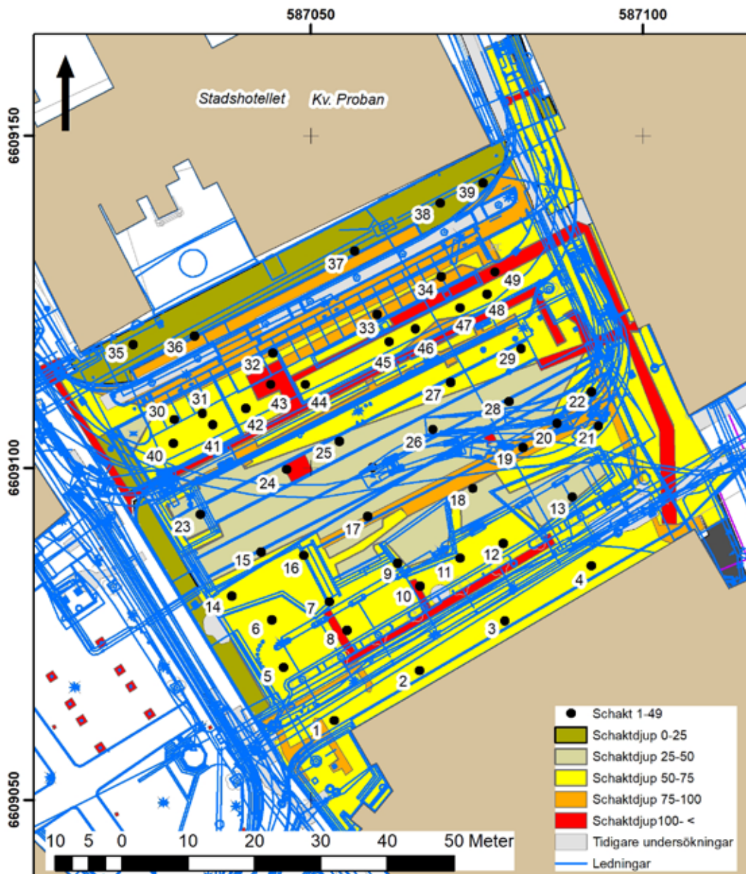
Figur 31. Undersökningsområdet med schakt 1–49 och planerade djup på olika ytor för omdaning av Stora torget. Vidare ses befintliga ledningar i området. Schakten placerades på ytor där inga ledningar fanns. Utdrag ur primärkartan. Skala 1:800.
