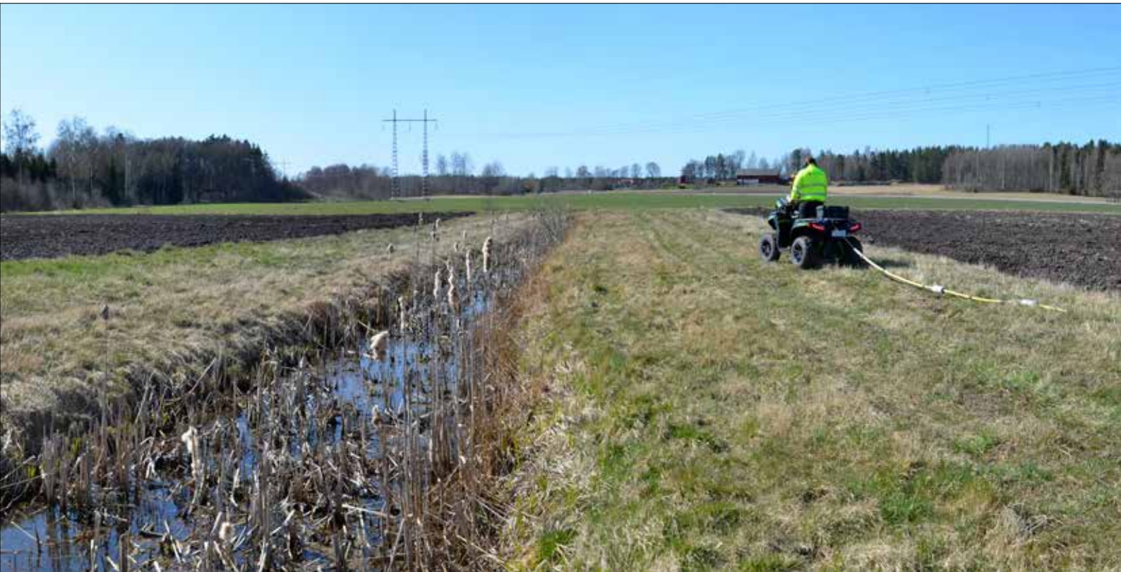
Figur 7.31. Carl Hoffstedt, Astacus AB, genomför markradarundersökning på Spångamossen. Foto: Fredrik Hallgren.
