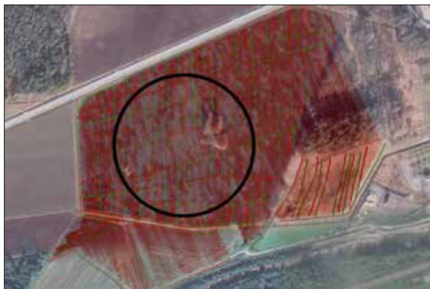
Figur 7.32. Interpolerad georadarbild för ett djup av cirka 125 cm ner i marken (Hoffstedt i bilaga 1).
