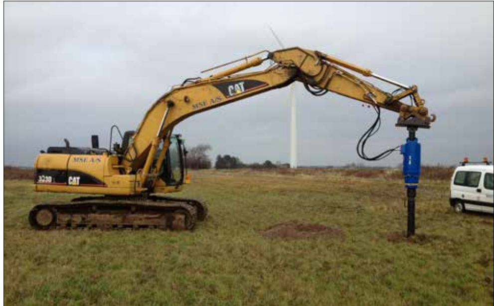
Figur 8.59. Prospekteringsborrning med kärnborr, för att klargöra lagertjocklek och bottentopografi inför de arkeologiska undersökningarna i Syltholmprojektet. Foto: @ Museum Lolland-Falster.
