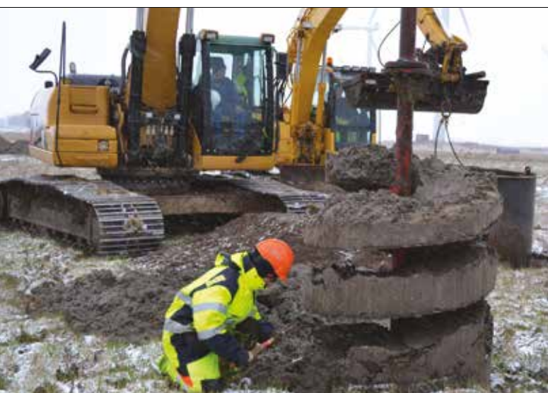
Figur 8.62. Borrning med snigelbör (Mortensen m.fl. 2015:figur 3).
